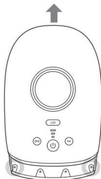
3 · 再次翻轉拆下橡膠腳墊和螺釘。(4處)
